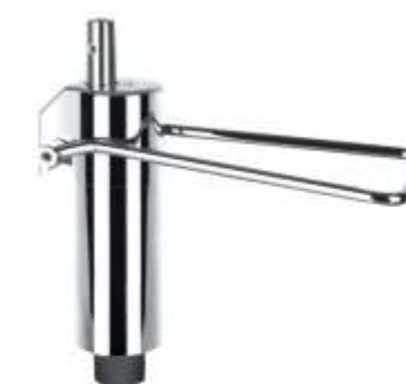
型号 (Item NO) : JX-07 重量 (Weight) : 5.9kg 初高 (Height) : 289mm 行程 (Stroke) : 108mm 压力 (Pressure) : 200kg
