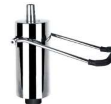
型号 (Item NO) : JX-10 重量 (Weight) : 12.2kg 初高 (Height) : 325mm 行程 (Stroke) : 180mm 压力 (Pressure) : 300kg
