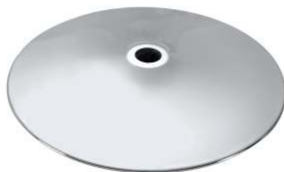
型号 (Item NO.): JX-R001 尺寸 (Size): \phi 550\text{mm} 材质 (Material): 铁 /Iron 表面处理 (Finish): 光铬 /Chrome 厚度 (Thickness): 1.8mm
